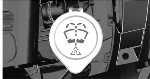
Alle Waschdüsen werden aus einem Behälter versorgt.
