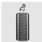
Zur Regelung der Beleuchtungsstärke muss das Stand- oder Abblendlicht eingeschaltet sein.
