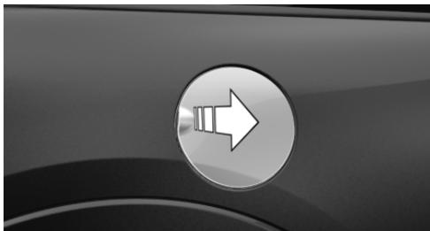
2. Tankverschluss gegen den Uhrzeigersinn drehen.
