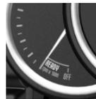
Die Anzeige signalisiert, dass die Auto Start Stop Funktion zum automatischen Motorstart bereit ist.
