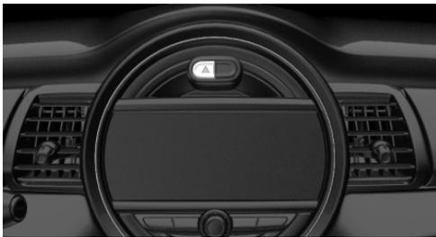
Die Taste befindet sich über dem Control Display.
