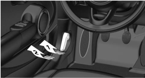
2. Nach Loslassen des Hebels, den Hebel erneut ziehen, Pfeil.
