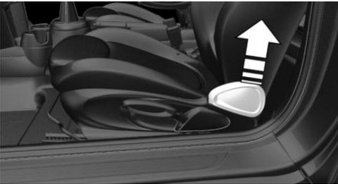
Hebel ziehen und die Lehne nach Bedarf be- oder entlasten.
