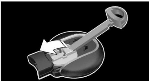
4. Batterie gleichen Typs mit der Plus-Seite nach oben einlegen.
