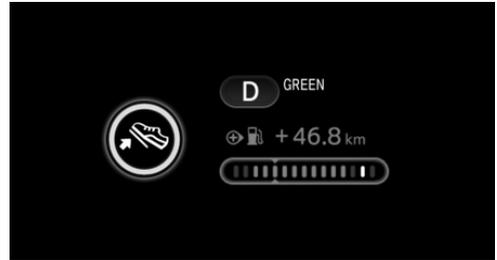
Der Hinweis zeigt an, dass die Fahrweise z. B. durch Gas wegnehmen verbrauchsgünstig angepasst werden kann.
