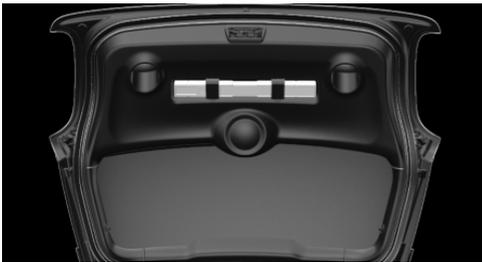
Das Warndreieck befindet sich in der Heckklappe. Zum Herausnehmen Halterungen lösen.
