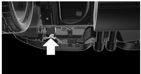
4. Defekte Lampe ersetzen.
