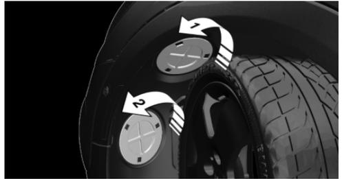
3. Innere Abdeckung gegen den Uhrzeigersinn drehen und herausnehmen.
