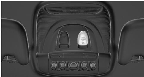
Die Kontrollleuchte der Beifahrerairbags zeigt den Funktionszustand der Beifahrerairbags an.
