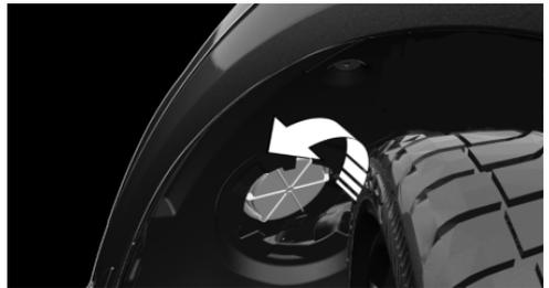
4. Lampenfassung aus dem Lampengehäuse ziehen, ggf. durch kleine Kippbewegungen lösen.
