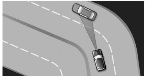
Beim Annähern an eine Kurve kann das System aufgrund der Kurvenkrümmung kurzzeitig auf Fahrzeuge der Nebenspur reagieren. Eine eventuelle Verzögerung des Fahrzeugs durch das System kann durch kurzes Gasgeben ausgeglichen werden. Nach dem Loslassen des Gaspedals ist das System wieder aktiv und regelt eigenständig die Geschwindigkeit.
