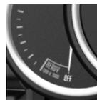
Die Anzeige signalisiert, dass die Voraussetzungen für einen automatischen Motorstopp nicht erfüllt sind.
