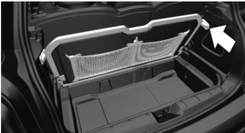
Variablen Ladeboden in der unteren Position hochklappen und hinter die Verriegelungen links und rechts drücken, Pfeil.
