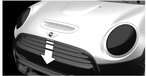
Aus ca. 40 cm Höhe fallen lassen und nachdrücken um die Motorhaube wieder vollständig zu verriegeln.
