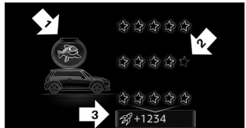
Die Anzeige des MINIMALISM Analysers besteht aus einem Fisch, der in einem Wasserglas auf dem Dach des MINI mitfährt und einer Wertetabelle, die in unterschiedlichen Kategorien die Fahrweise bewertet. Unterhalb der Wertetabelle wird die erzielte Bonusreichweite durch eine verbrauchsschonende Fahrweise angezeigt.
