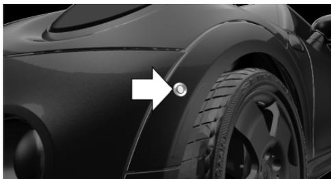
Die Ultraschallsensoren zum Vermessen der Parklücken befinden sich an den Radläufen.
