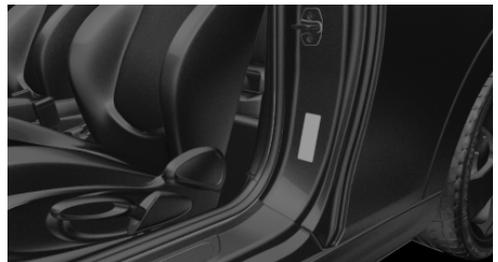
Druckangaben für freigegebene Reifengrößen befinden sich an der Türsäule der Fahrertür.
