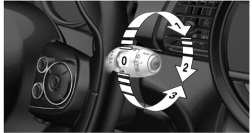
Schalter aus Ruhestellung 0 nach oben drehen, Pfeil 1: Intervallbetrieb. Bei eingelegetem Rückwärtsgang erfolgt Dauerbetrieb.
