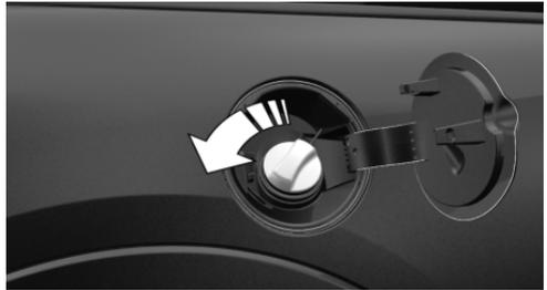
3. Tankverschluss in die Halterung an der Tankklappe stecken.
