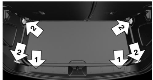
Ohne Ablagenpaket: Zur Sicherung der Ladung befinden sich zwei Verzurrösen, Pfeil 1, im Gepäckraum.
