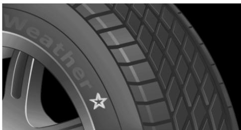
Je Reifengröße werden bestimmte Reifenfabrikate vom Hersteller Ihres Fahrzeugs empfohlen. Diese sind an einem Stern auf der Reifenseitenwand erkennbar.
