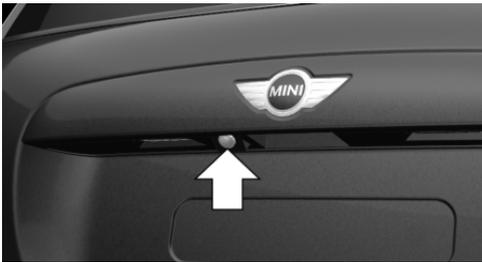
Das Objektiv der Kamera befindet sich in der Griffleiste der Heckklappe. Durch Schmutz kann die Bildqualität beeinträchtigt werden.
