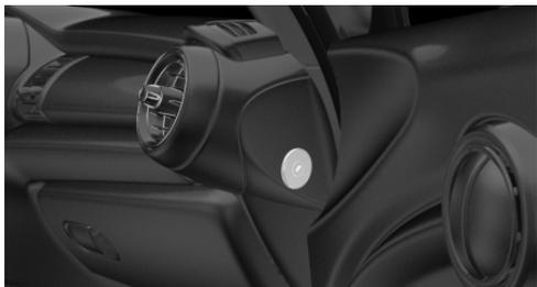
Front- und Seitenairbag für den Beifahrer können mit dem integrierten Schlüssel aus der Fernbedienung deaktiviert und wieder aktiviert werden.
