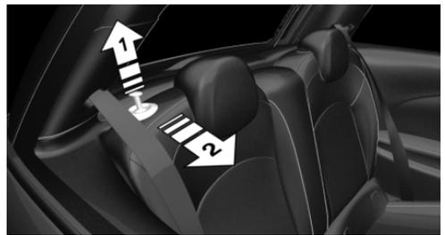
Entriegelung nach oben ziehen und Rückenlehne nach vorn klappen.
