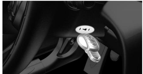
Automatic-Getriebe: Bei entsprechender Check-Control-Meldung die Fernbedienung, wie abgebildet, an die Markierung an der Lenksäule halten und innerhalb von 10 Sekunden bei getretener Bremse den Start-/Stopp-Knopf drücken.
