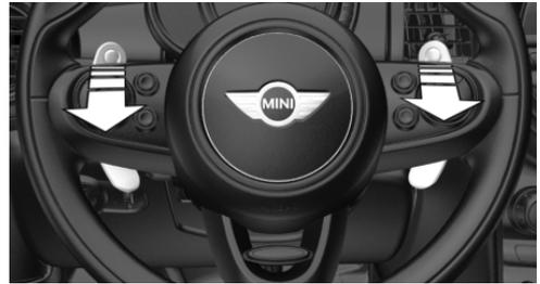
Die Schaltwippen am Lenkrad ermöglichen einen schnellen Wechsel der Gänge, wobei beide Hände am Lenkrad bleiben können.
