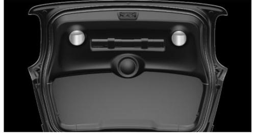
Griffmulden an der Innenverkleidung der Heckklappe erleichtern das Herunterziehen.
