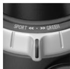
Fahrerlebnisschalter nach rechts drehen, bis in der Instrumentenkombination GREEN Mode angezeigt wird.
